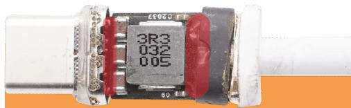
TYPE-C线芯焊点保护/钢套粘接
